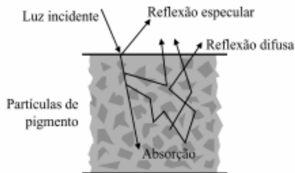
Figura 9. Efeitos da presença de corantes em um vidrado cerâmico.
